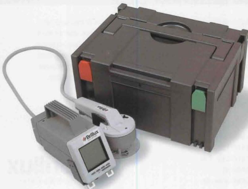
*Komplett ausgestattet: Farbmess-einheit und praktische Arbeitsgeräte zur individuellen Analyse im Brillux Systainer.*
